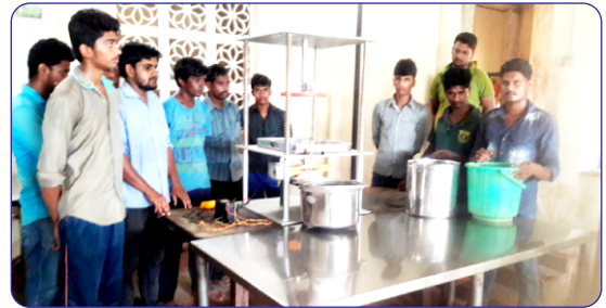
UAHS Designed Hydraulic Cashew juice extractor ವಿಶ್ವವಿದ್ಯಾಲಯದ ವಿನ್ಯಾಸಿತ ಗೇರು ಹಣ್ಣಿನ ರಸ ತೆಗೆಯುವ ಯಂತ್ರ
