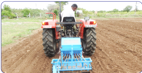
Design and modification of onion seed drill ಈರುಳ್ಳಿ ಬೀಜದ ಕೂರಿಗೆ ಬಿತ್ತನೆ ವಿನ್ಯಾಸ ಮತ್ತು ಮಾರ್ಪಾಡು
